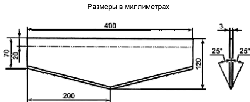
Рисунок 7 - Стальное лезвие для инициирования трещины в полиэтиленовой трубе
